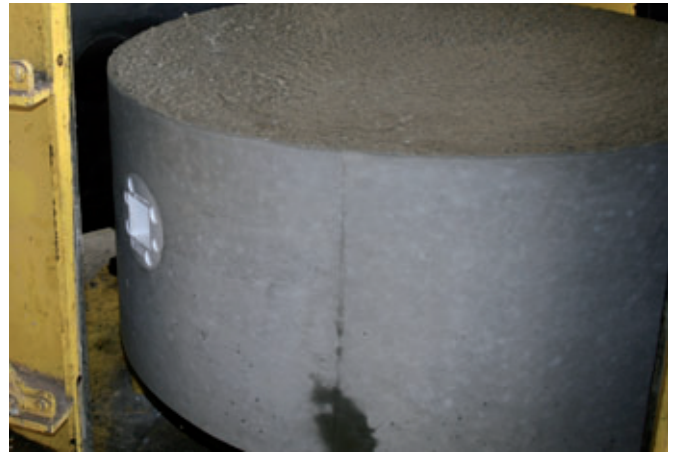
Fondi pozzetto induriti dopo l'apertura dello stampo
