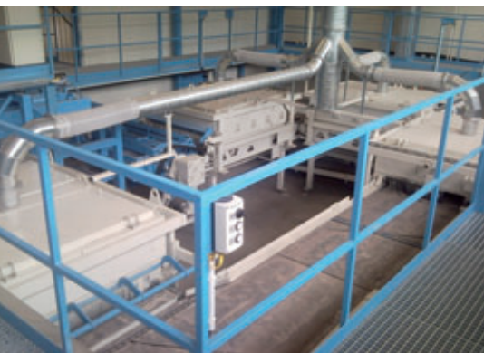
Le Tumble Master avec ses 4 stations de tambourinage et le retourneur de lits de blocs
