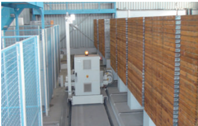
Dispositif d'insertion de 2 ou 4 baguettes
