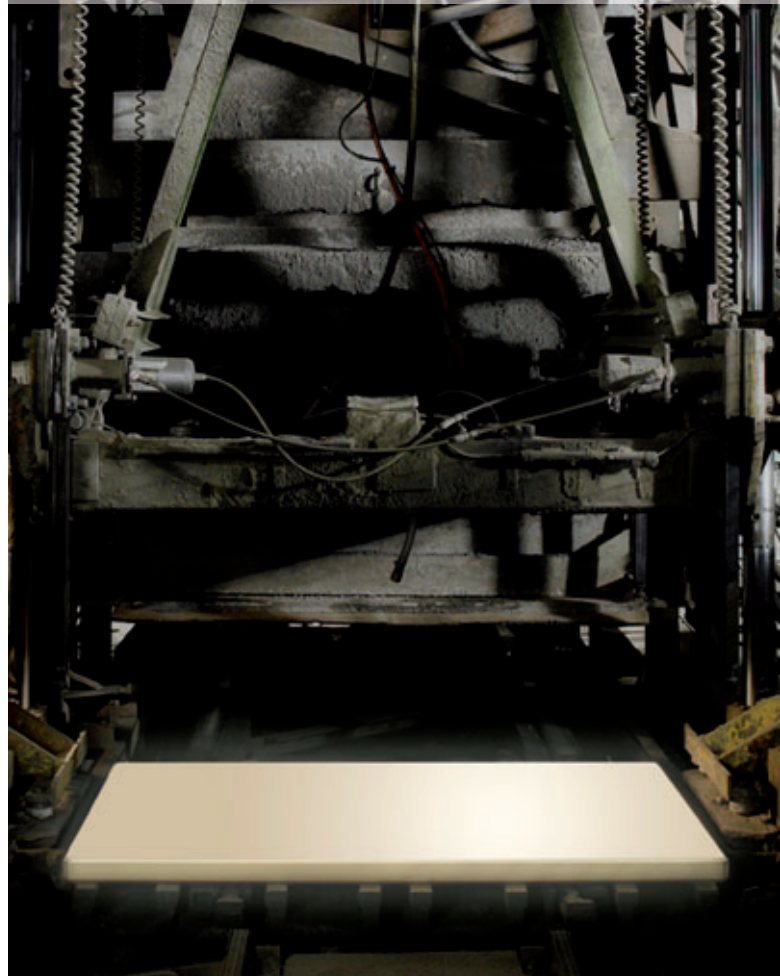
Dispositif de mise en paquets avec servomoteurs et courroies dentées
