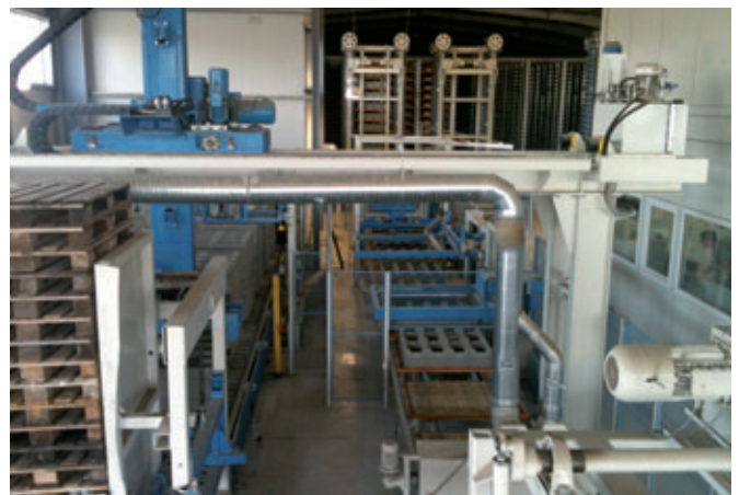
Côté sec avec dispositif d'insertion de papier/film plastique et cerclage horizontal
