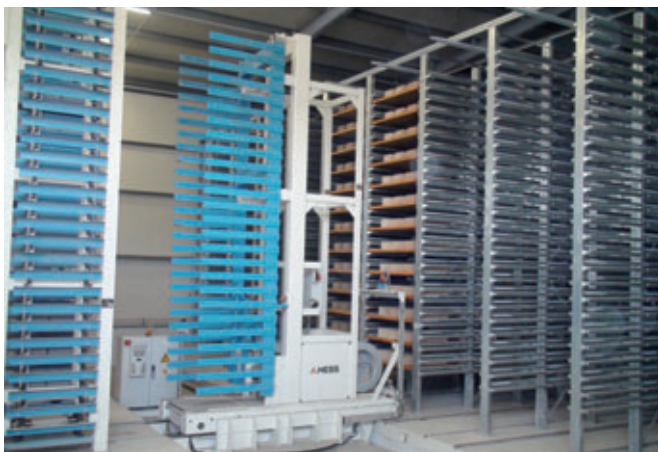
Transstockeur à 26 étages et mécanisme rotatif
