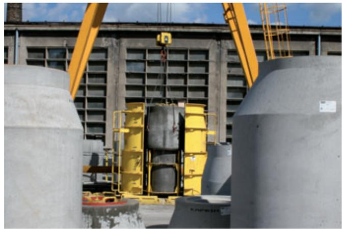
Après un temps de durcissement suffisant, les moules sont ouverts et les cônes sont enlevés avec précaution au moyen d'une grue.
