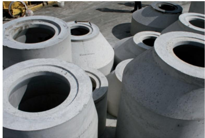
La hauteur des cônes peut être réglée au choix jusqu'à un maximum de 2350 mm.
