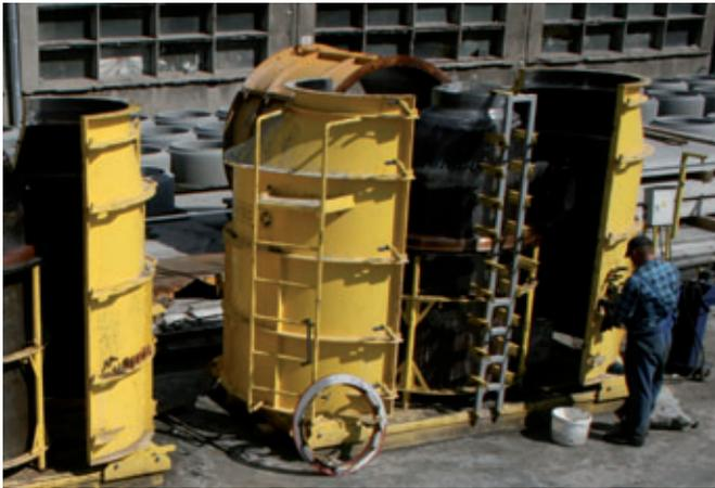
Afin de placer avec précision les douilles coniques pour les étriers, un gabarit spécifique est accroché au noyau du moule.
