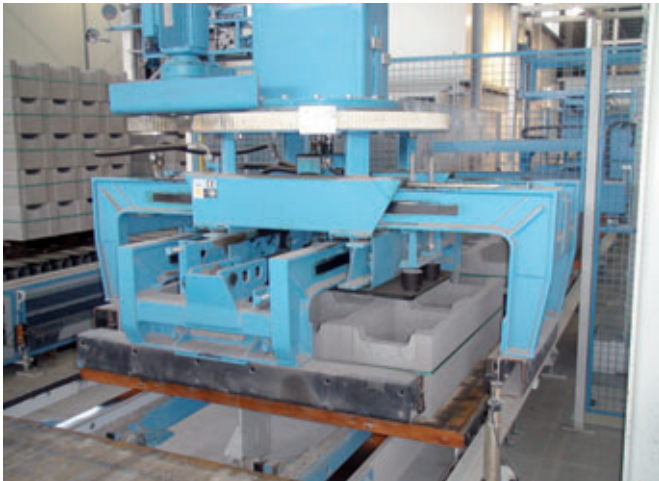
Paketierer mit Servoantrieben und Zahnriemen
