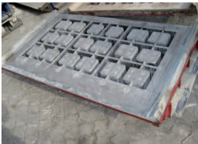
Износ формы для пустотных блоков с твердостью по технологии «carb» после 50 000 производственных циклов
