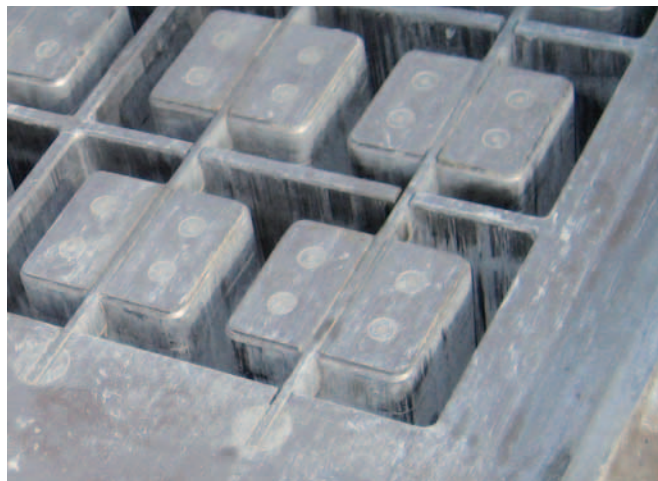
Устойчивые болтовые соединения опоры сердечника обеспечивают точную подгонку обрабатываемых на станках с ЧПУ съемных сердечников
