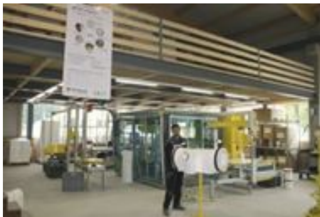
Wycinanie kształtek gorącym drutem i montaż modelu kinety odbywa się w tylnej części hali. Powyżej znajduje się magazyn kształtek styropianowych.
