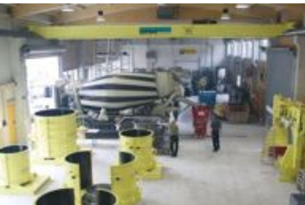
Gruszki wjeżdżają tyłem do hali i beton przelewany jest do mobilnego silosu.
