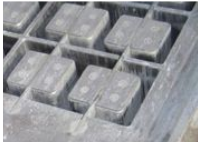
Solidne połączenia śrubowe przy wsporniku rdzeni umożliwiają dokładne dopasowanie wymiennych rdzeni, poddanych obróbce CNC, w gniazdach formy.
