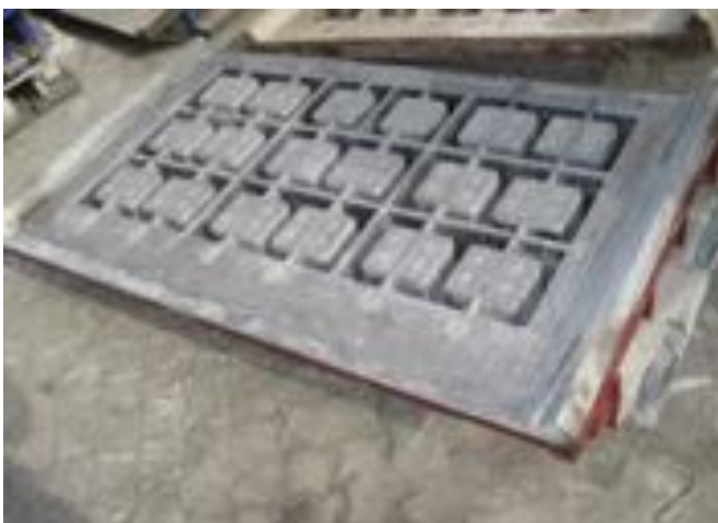
Zużycie formy do pustaków betonowych wykonanej w technologii »carbo« po 50 000 cykli produkcyjnych.
