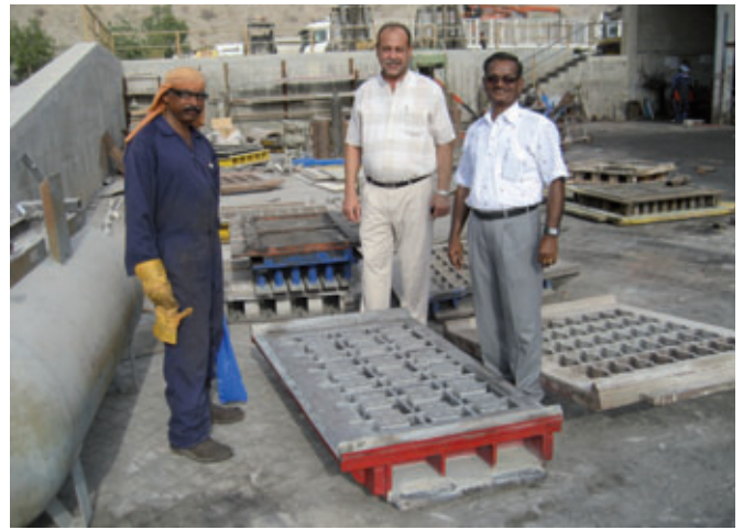
L'innovativo sistema di avvitemento delle anime rappresenta un modo per semplificare la manutenzione degli stampi per la National Tiles & Blocks Ltd. di Ras-Al-Khaimah, EAU
