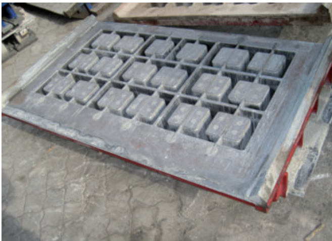
"Dopo più di 50.000 cicli di produzione, lo stampo per blocchi con tempra »carbo™« non presenta alcun segno visibile di usura"
