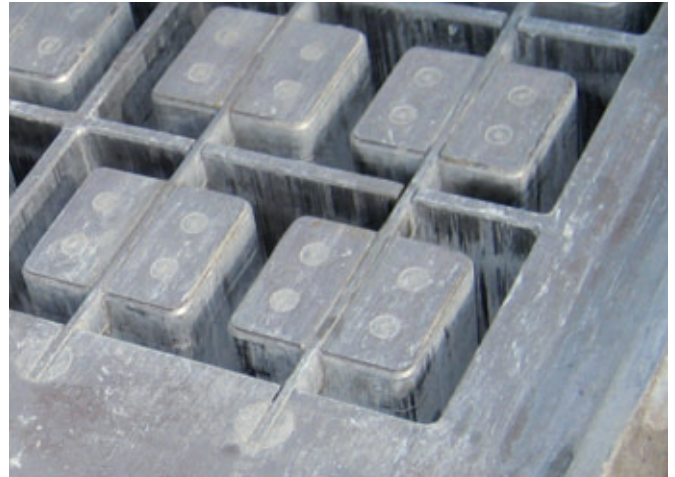
Connessioni vitate stabili sull'asta supporto anime permettano l'accoppiamento nella cavità del anima intercambiabili e realizzati con lavorazione CNC
