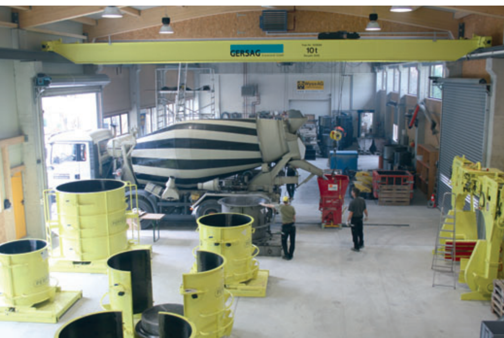
Die Fahr-mischer fahren rückwärts in die Halle und der Beton wird in einen Betonkübel gegeben
