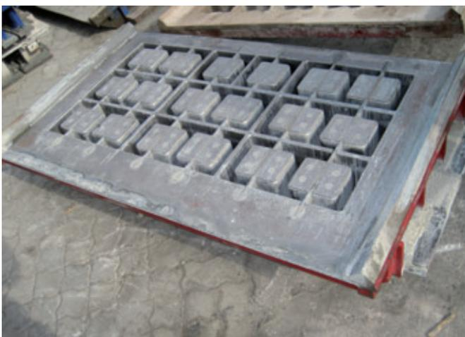
Nach über 50.000 Produktionstakten ist bei der Hohlblockform in »carbo«-Härte kein Verschleiß sichtbar
