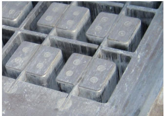
Stabile Schraubverbindungen am Kernhalter ermöglichen die exakte Passung der CNC-bearbeiteten, austauschbaren Einzelkerne im Steinfeld
