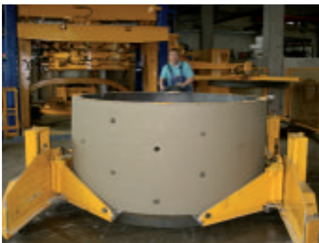
Продукты отвозятся от установки с помощью отвозной тележки
