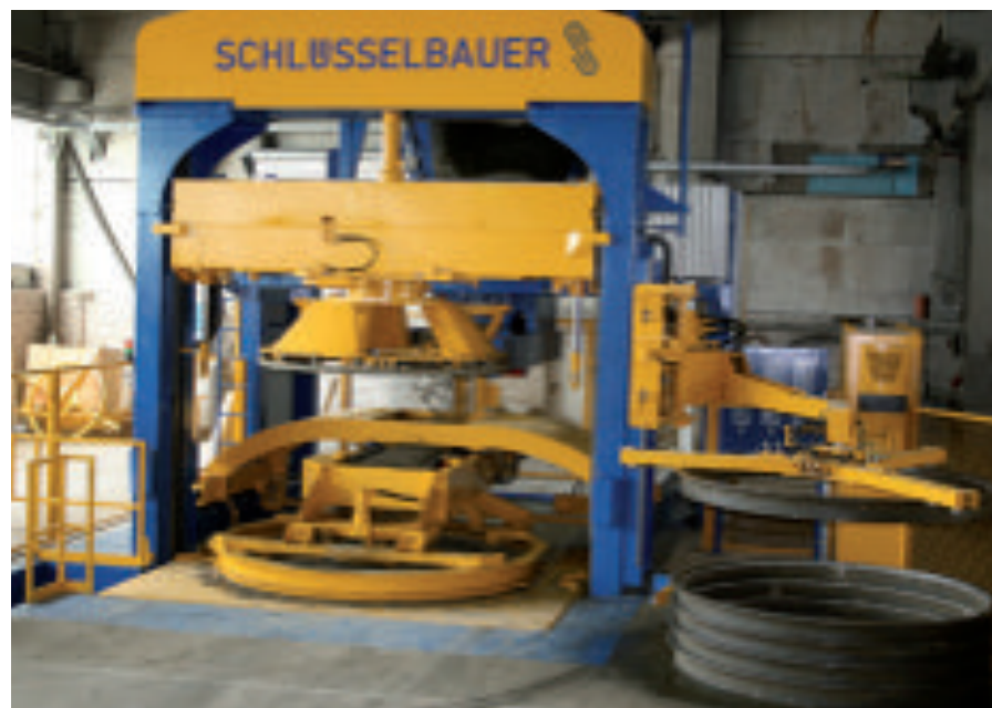
Производственная установка Magic 2500 для изготовления продуктов диаметром до 2700 мм
