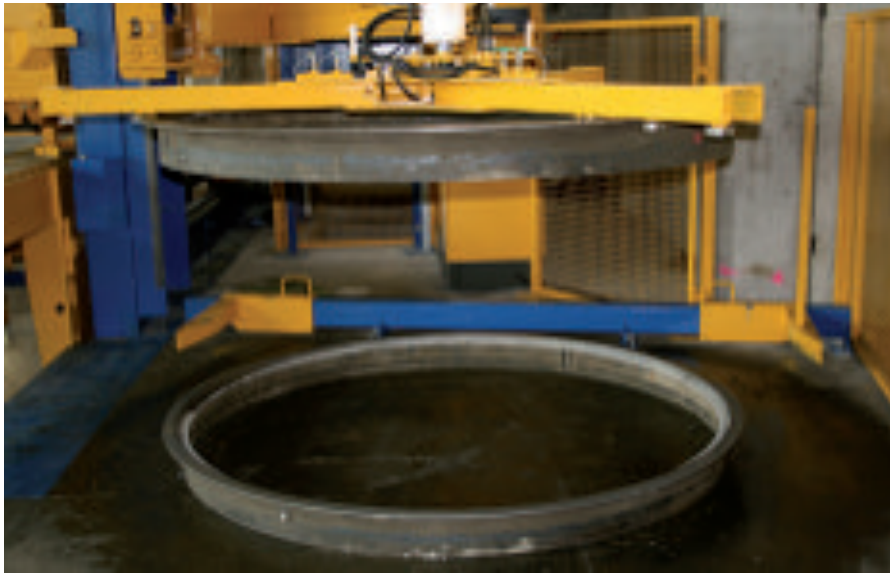
Автоматическая подача поддонов делает возможным обслуживание всей установки одним сотрудником
