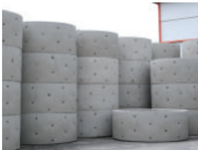
Дренажные кольца диаметром 2500 на складе
