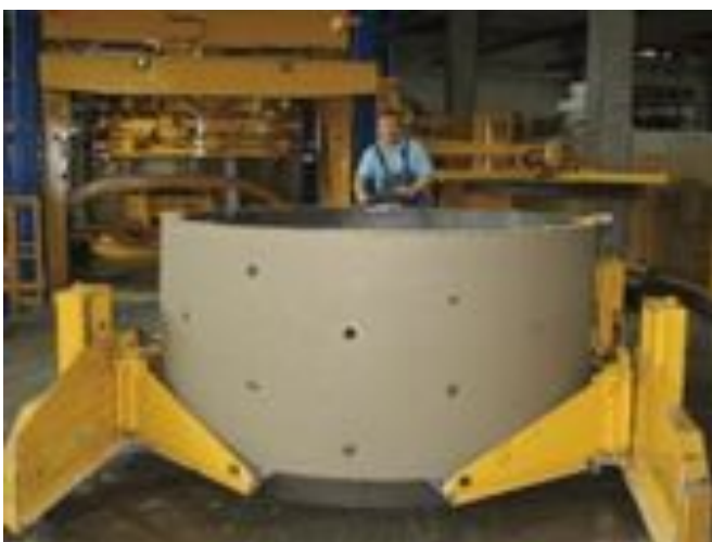
Wyroby odtransportowywane są od maszyny przy pomocy specjalnego wózka akumulatorowego.
