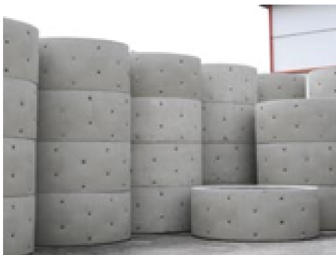
Kręgi drenażowe DN 2500 w magazynie zewnętrznym.
