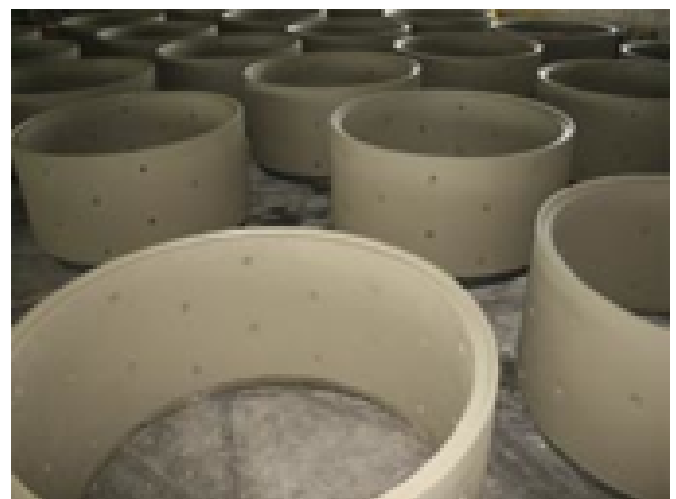
Dojrzewające kręgi drenażowe DN 2500.
