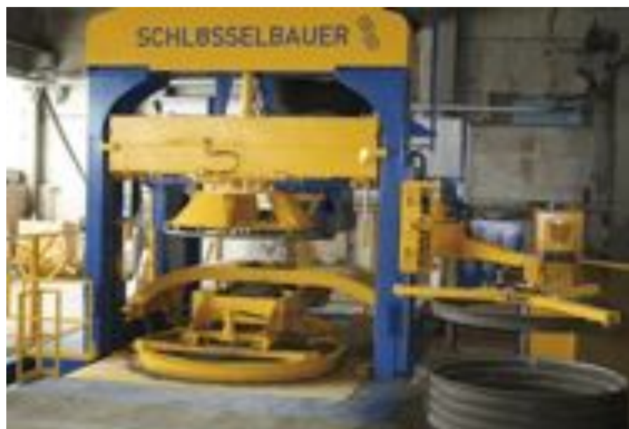
Maszyna Magic2500 produkuje elementy prefabrykowane o średnicy zewnętrznej do 2 700 mm.
