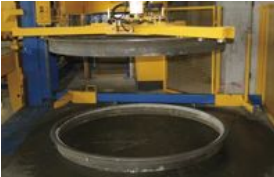
Automatyczne wprowadzanie do maszyny pierścieni dolnych pozwala na jednoosobową obsługę.
