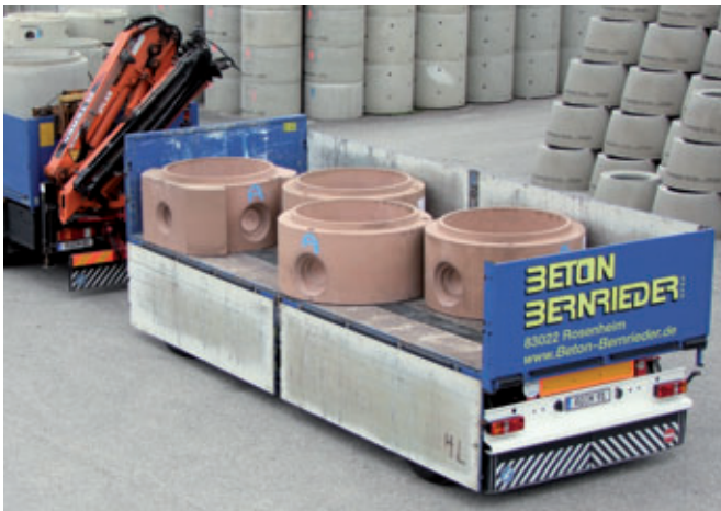
Le basi per pozzi in calcestruzzo Perfect monolitici prodotte su misura vengono realizzate con calcestruzzo standard C40/50 e calcestruzzo ad alta resistenza C60/75.
