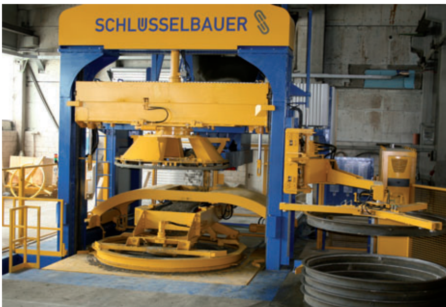
L'impianto di produzione Magic2500 per la realizzazione di pezzi finiti con un diametro esterno fino a 2700 mm.
