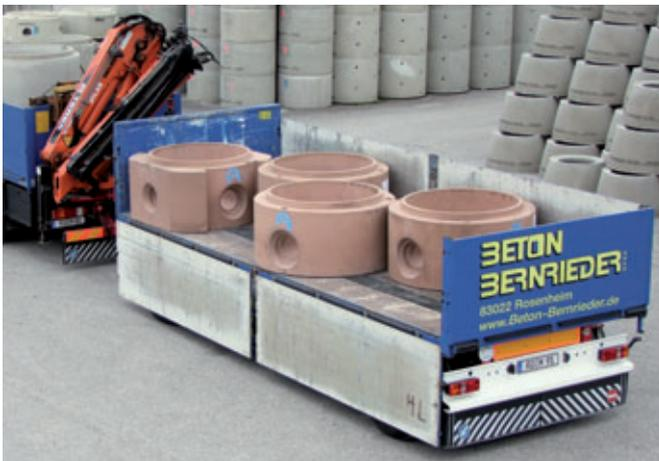
Les fonds de regard Perfect en béton, monolithiques et fabriqués sur mesure, sont réalisés en béton standard C40/50 et en béton HL C60/75.
