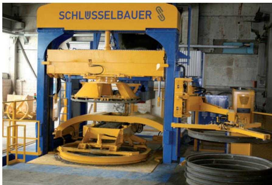
L'installation de production Magic2500 pour la fabrication de pièces préfabriquées d'un diamètre extérieur allant jusqu'à 2.700 mm.
