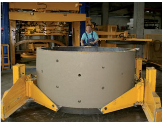
Der Abtransport der Produkte aus der Anlage erfolgt mit elektrischem Abfahrwagen
