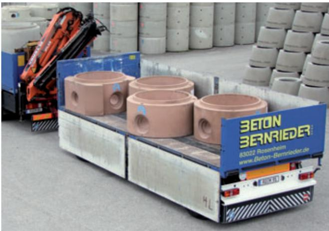
Maßgefertigte monolithische Perfect-Betonschachtunterteile werden aus Standardbeton C40/50 und aus HL-Beton C60/75 gefertigt
