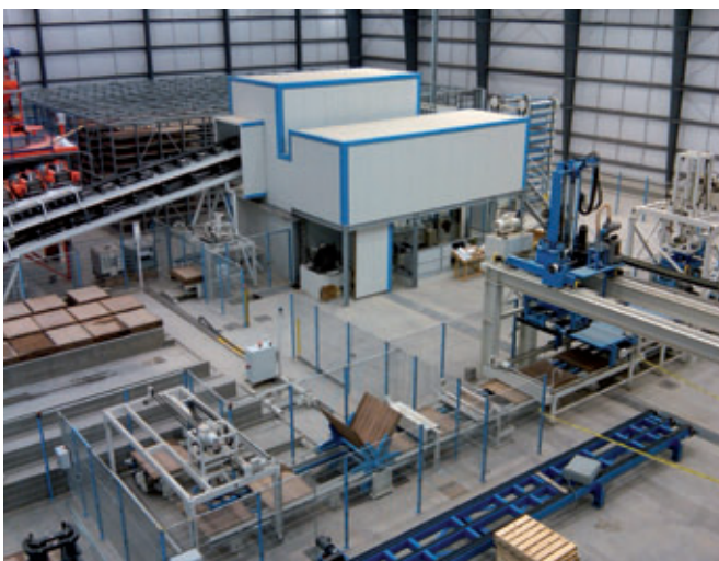
Рис. 1: Благодаря автоматизации установки компания Sims Stone оптимально приспособила производство на участке «мокрая сторона» к производству на участке «сухая сторона», что позволило достигнуть наилучших результатов по качеству, количеству и затратам на единицу продукции.
