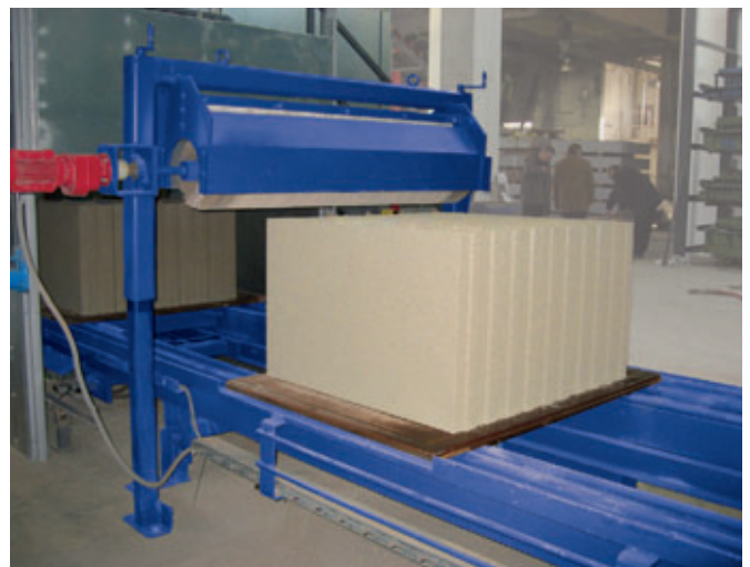
Продукция, изготовленная на установке Masa XL 9.1 с использованием вибростола Aluminium. Максимальные габариты продукции в настоящее время составляют 1000 x 240 x 623 мм (длина x ширина x высота)
