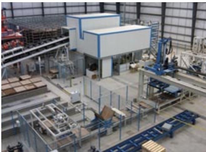
1: W projekcie zautomatyzowanego zakładu firmy Sims Stone zoptymalizowano współpracę linii mokrej z suchą w celu zapewnienia jak najlepszych wyników pod względem jakości wyrobów, przepustowości linii i kosztu produkcji elementów.
