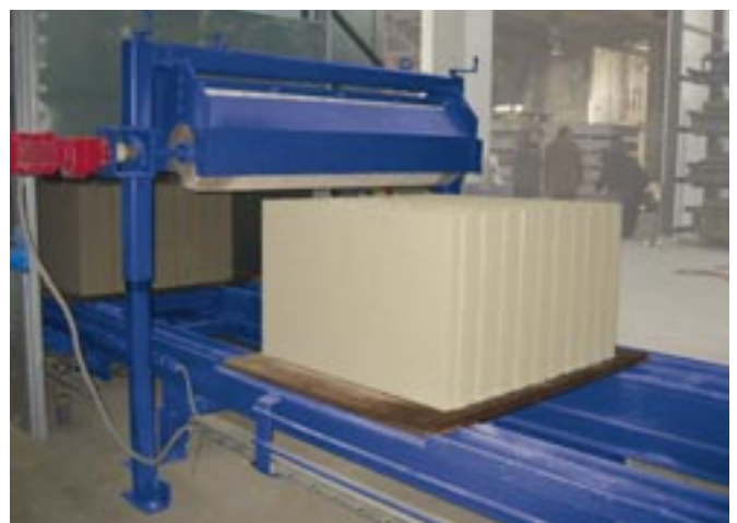
Wyroby w wibroprasie Masa XL 9.1 z aluminiowym stołem wibracyjnym, maks. wymiary produkowanych obecnie elementów 1000 x 240 x 623mm (długość x szerokość x wysokość)
