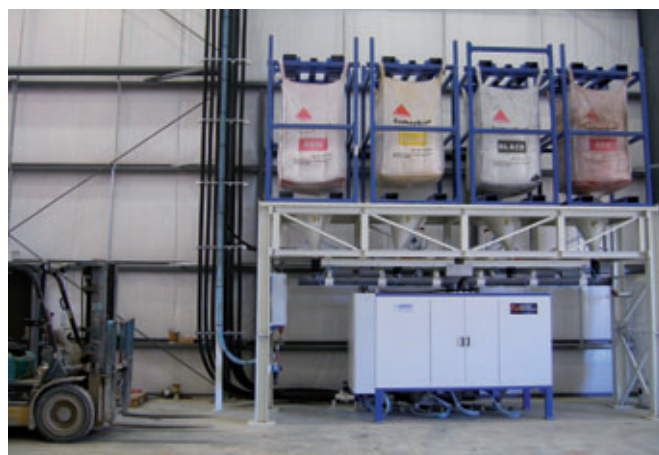
Fig. 5: Il sistema di dosaggio di precisione del granulato colorato Würschum COM 70-3, con sistema pneumatico di alimentazione da tre diversi serbatoi trasmettenti a pressione, per un funzionamento ad alte prestazioni completamente automatico e privo di polveri, forma un circuito chiuso
