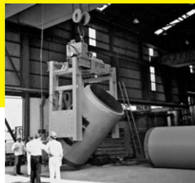
Pinza di ribaltamento per gru a cavalletto PW G-R: l'integrazione perfetta di ogni carroponete.
