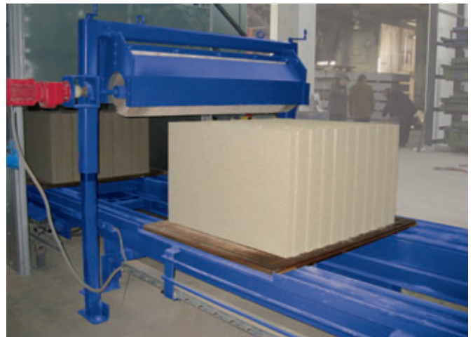
Prodotti sulla tavola vibrante in alluminio Masa XL 9.1, attuali dimensioni massime dei prodotti realizzate 1000x240x623mm (lunghezza x larghezza x altezza)
