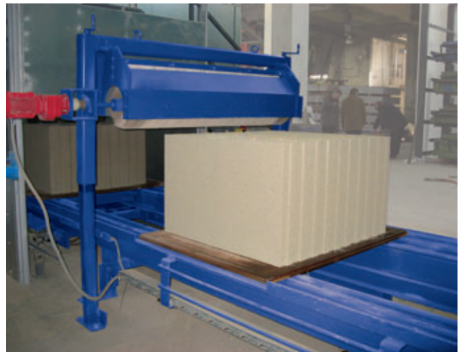
Produkte auf Masa XL 9.1 mit Aluminium Vibrationstisch, max. gefertigte Produktgröße z. Zt. 1000 x 240 x 623 mm (Länge x Breite x Höhe)
