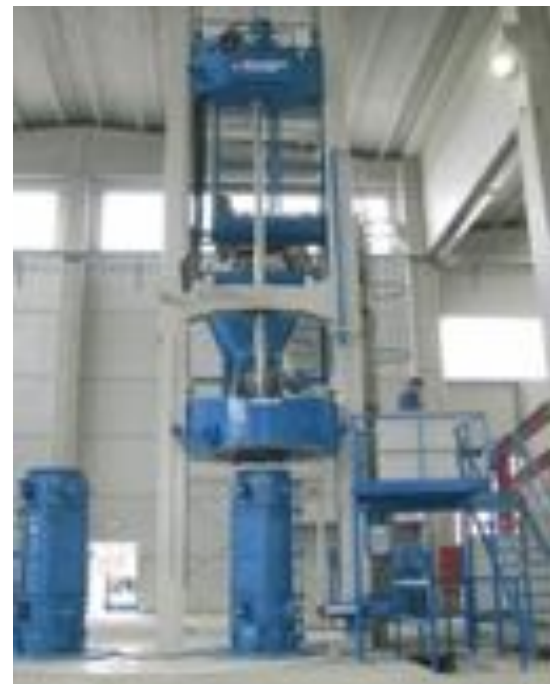
Schlosser Pfeiffer zaprezentuje na targach bauma 2010 w pełni udoskonaloną prasę radialną RP 1225 T.
