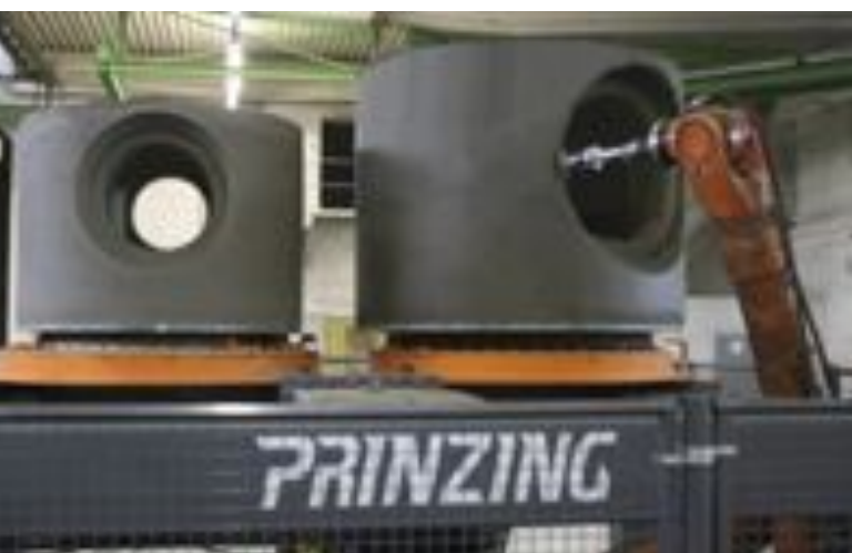
Robot do frezowania Primuss całkowicie automatycznie wycina różne kanały i przyłącza w podstawach studni.
