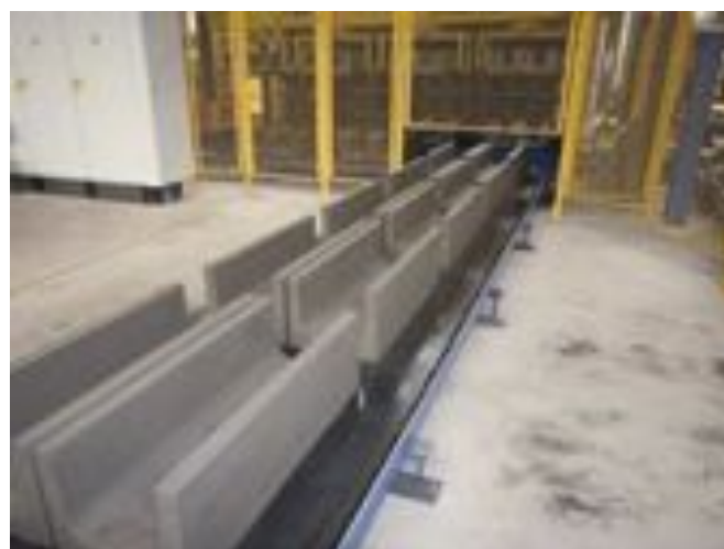
Kanały w kształcie litery „U” na linii Blizzard.
