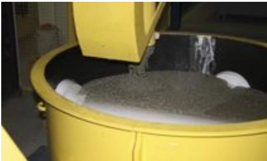
Głowica dozująca pozwala na optymalne zalewanie formy.
