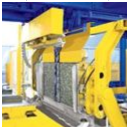
Linie technologiczne do produkcji betonowych płyt
