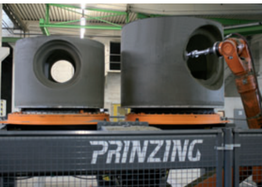
Primuss fresa canaletti e raccordi variabili in fondi di pozzetti in modo totalmente automatico
