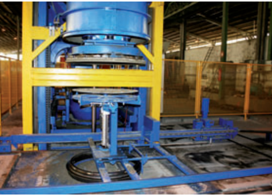
Tornado con macchina automatica degli ancoraggi
