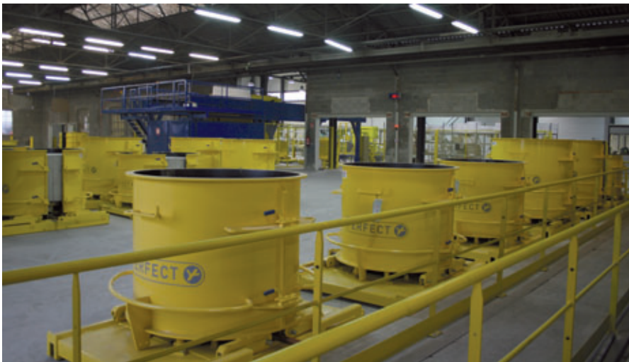
Gli stampi appena riempiti vengono trasportati nell'area di stoccaggio per mezzo di un carrello di espulsione
