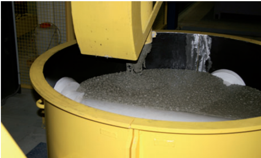
La testa di iniezione del calcestruzzo presente nella postazione assicura un riempimento ottimale dello stampo
