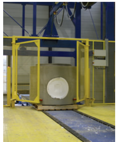
...e depositati sul nastro trasportatore che li porterà all'ultima stazione di lavorazione, dove i corpi sagomati in polistirolo espanso vengono rimossi dagli elementi di fondo per pozzi
