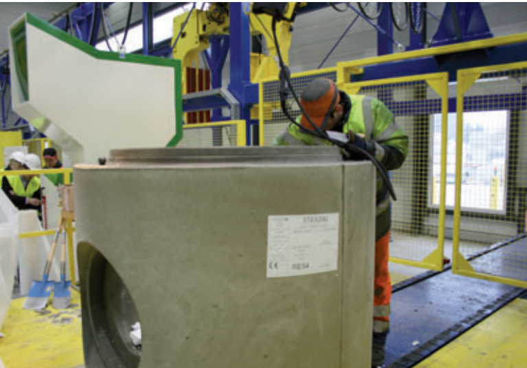
Démoulage et recyclage du polystyrène
