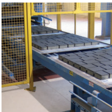
Installation pour la fabrication des blocs en béton
