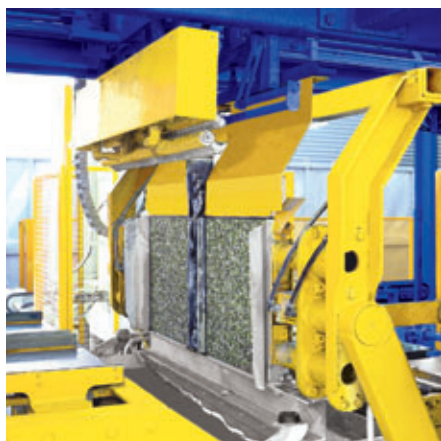
Installation pour la fabrication des dalles en béton
