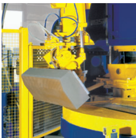
Installation pour la fabrication des bordures
