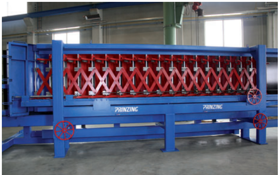
Treppenschalung Sirius mit Schnellverstellung
