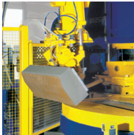
Anlagen für die Bordsteinfertigung
