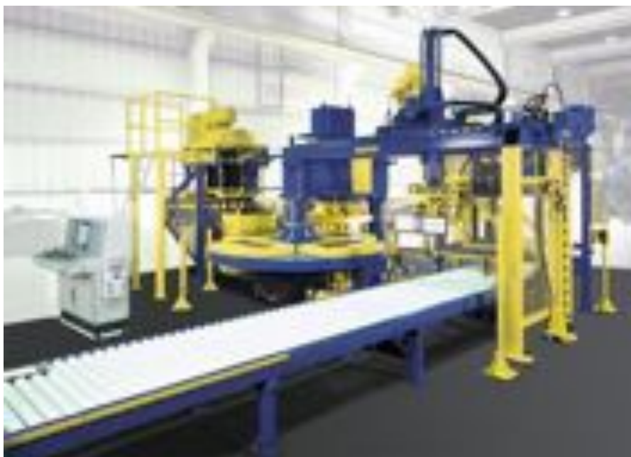
Czterostanowiskowa prasa ze stołem obrotowym.
