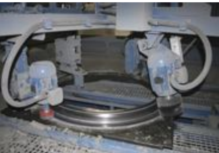
Cleanmaster – w pełni zautomatyzowana stacja czyszczenia pierścieni dolnych.
