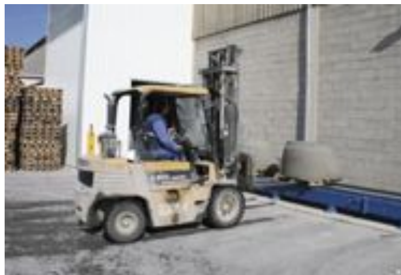
Prefabrykaty betonowe przewożone są wózkiem widłowych na plac składowy.
