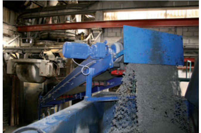
Il calcestruzzo viene alimentato a Magic 1501 dai miscelatori dell'attuale produzione di calcestruzzo di Frühwald
