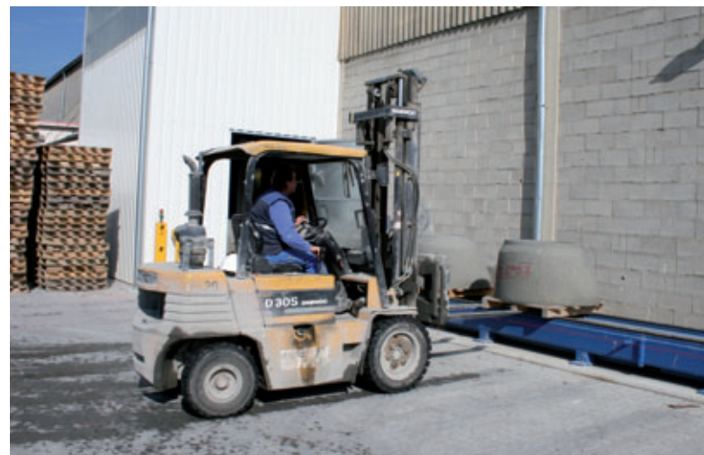
I pezzi finiti in calcestruzzo vengono portati tramite carrelli elevatori alle loro postazioni provvisorie nel deposito esterno
