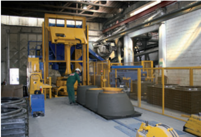
Magic 1501, a destra nella foto il caricatore di fondelli davanti alla stazione di lubrificazione
