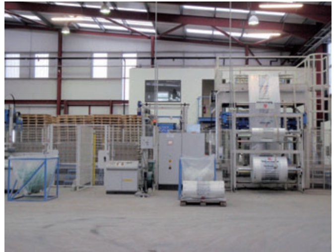
La maggior parte dei pallet viene impacchettata con una pellicola trasparente con logo Tobermore visibile
