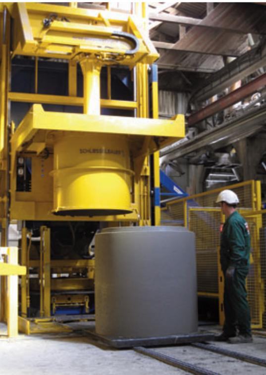
*La Magic est conçue pour fabriquer des produits de diamètre extérieur maximal 1800 mm et de hauteur maximale 1500 mm*
