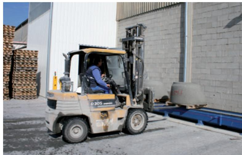
*Les produits béton préfabriqués sont placés sur le parc extérieur au moyen d'un chariot élévateur à fourches.*
