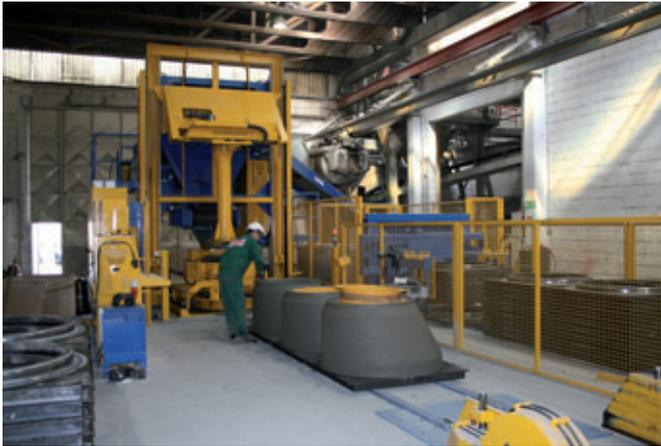
Magic 1501, à droite sur la photo le magasin d'embases devant la station de lubrification.
