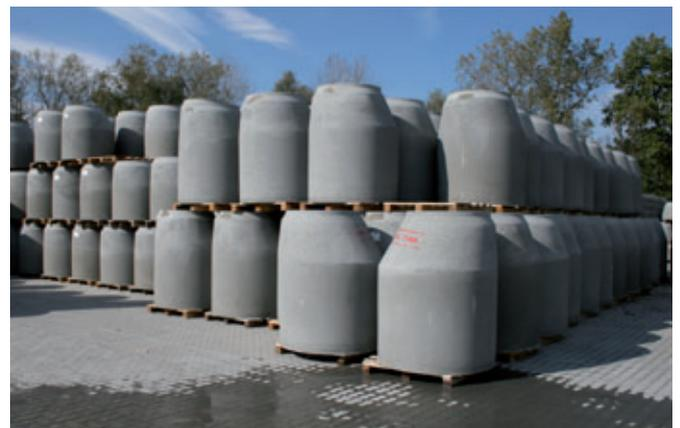
*Chez Tiba éléments de regards et têtes réductrices sont fabriqués sur la nouvelle Magic 1501 dans de multiples dimensions.*
