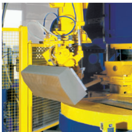
Installation pour la fabrication des bordures
