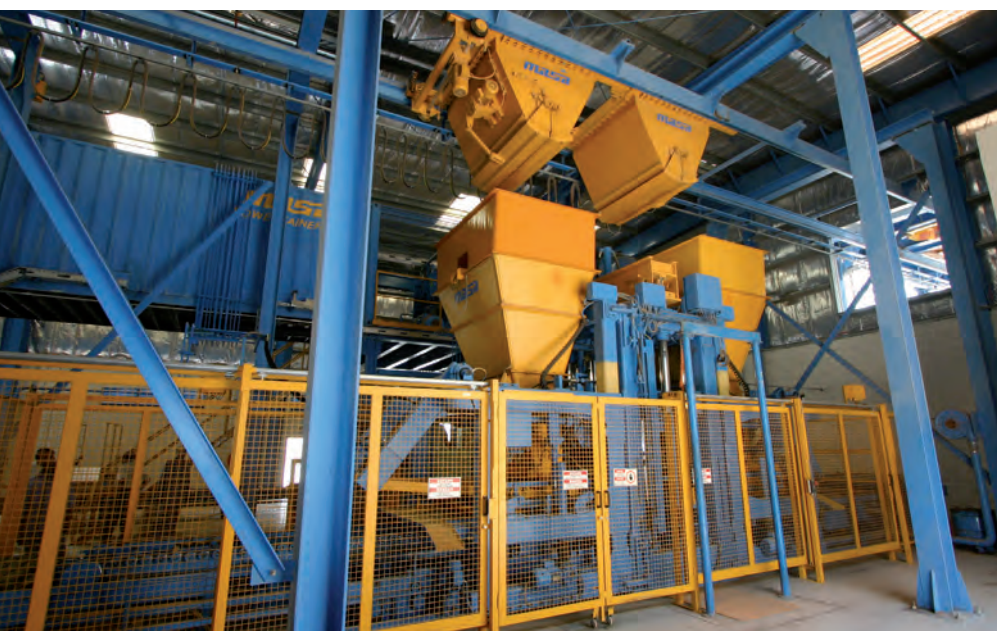
Машина XL 9.2 с ковшевым конвейером для производства бетонных блоков
