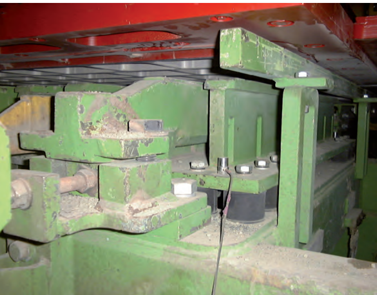
Положение одного из датчиков колебаний при измерении вибраций в 5-ти точках
