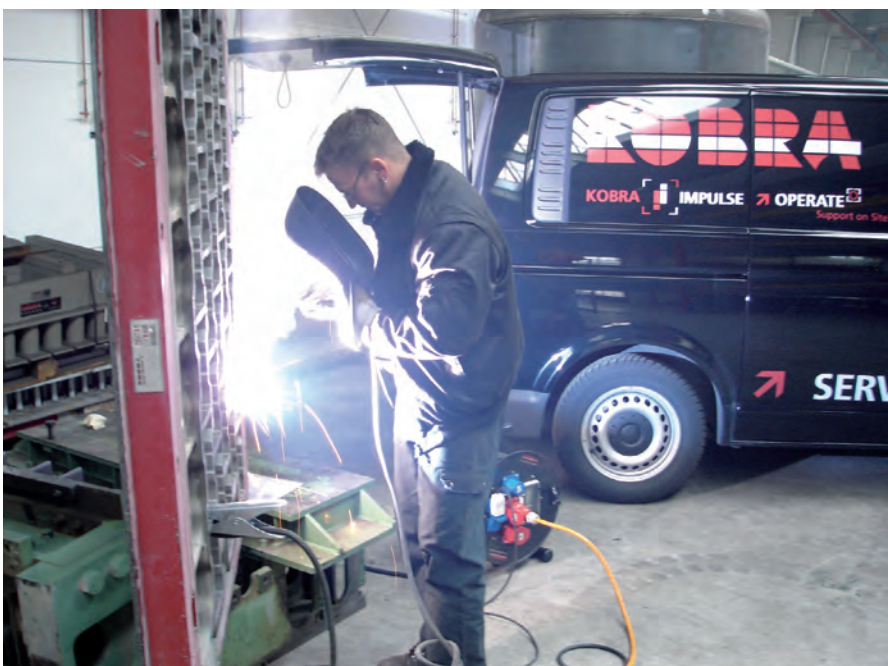
Специалист по обслуживанию осуществляет ремонт на месте на заводе ЖБИ
