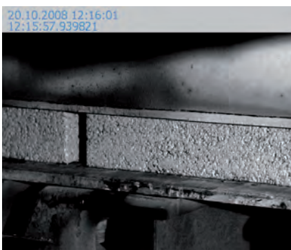
Снимки видеокamеры – из-за недостаточного пригруза при распалубке камни сначала поднимаются вместе с формой с поддона и затем резко опускаются
