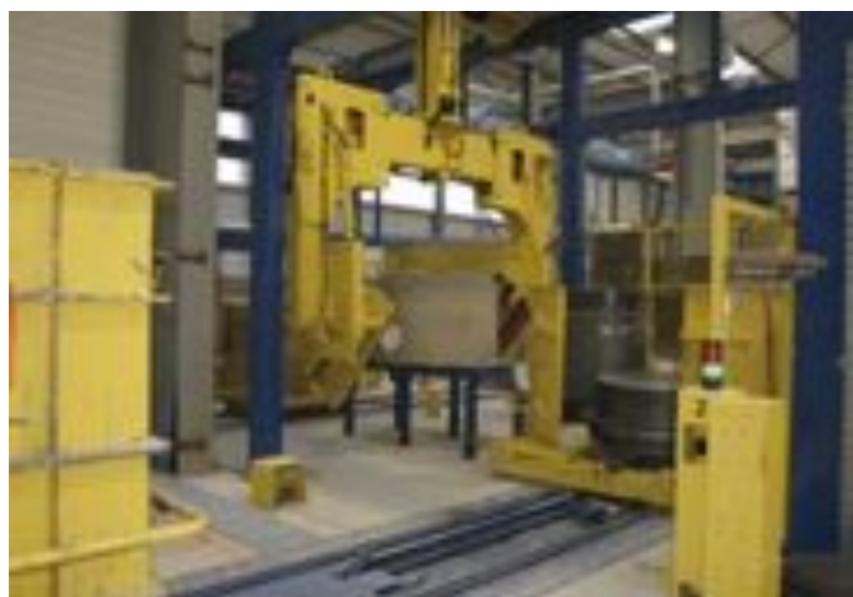
Wycinanie dennic z form i ich obracanie odbywa się w pełni automatycznie.
