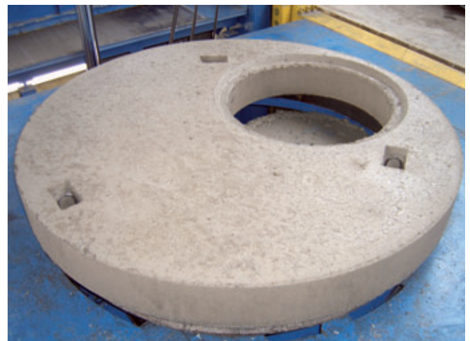
Lastre di copertura con ancore di trasporto
