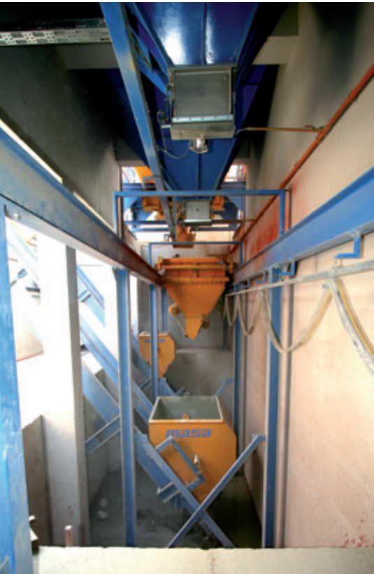
Contenitore di pesatura mobile Masa con elevatore mescolatore.
