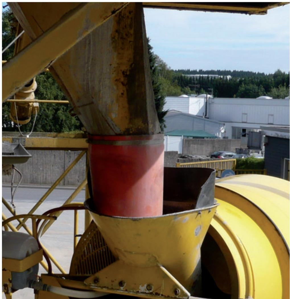
Le matériau est beaucoup moins sensible aux forces de cisaillement et d'écrasement qui apparaissent au niveau de la trémie de la bétonnière.
