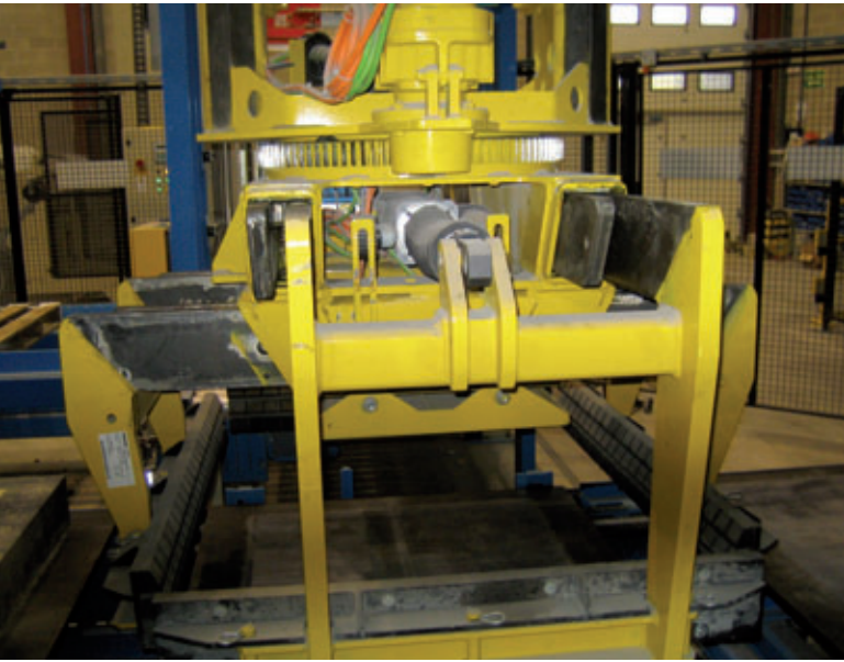
Robot de mise en paquet avec pince servocommandée
