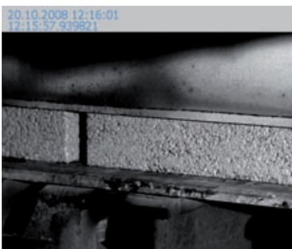
Aufnahmen einer Highspeed-Kamera – wegen zu geringem Auflastgedruck heben die Steine beim Entschalen zunächst mit der Form vom Fertigungsbrett ab und lösen sich dann schlagartig.
