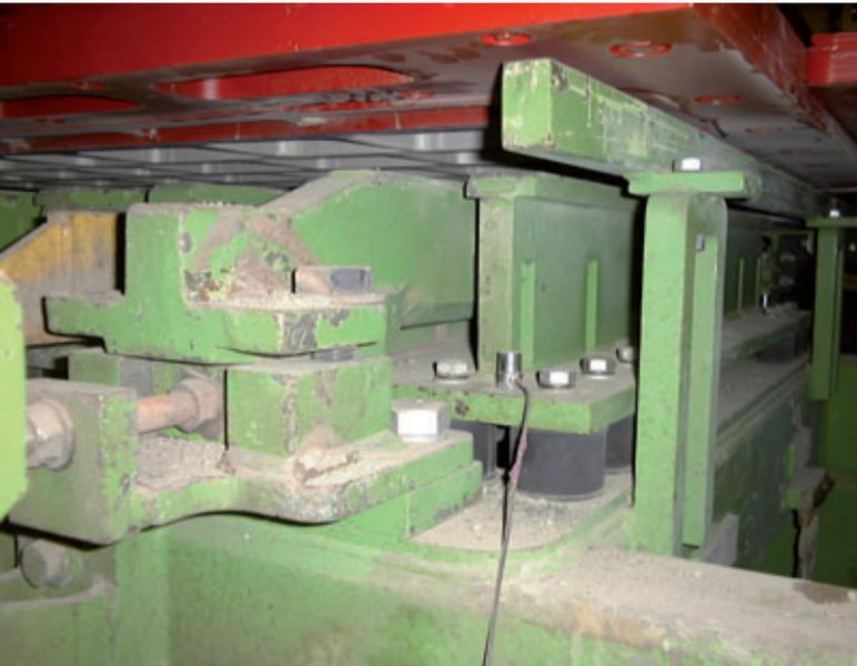
Position eines Schwingungssensors bei der 5-Punkt-Schwingungsmessung
