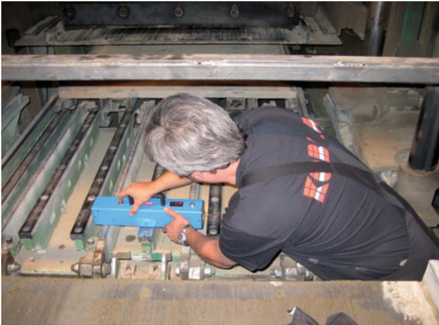
Spaltmessung an den Schlagleisten eines Rütteltisches
