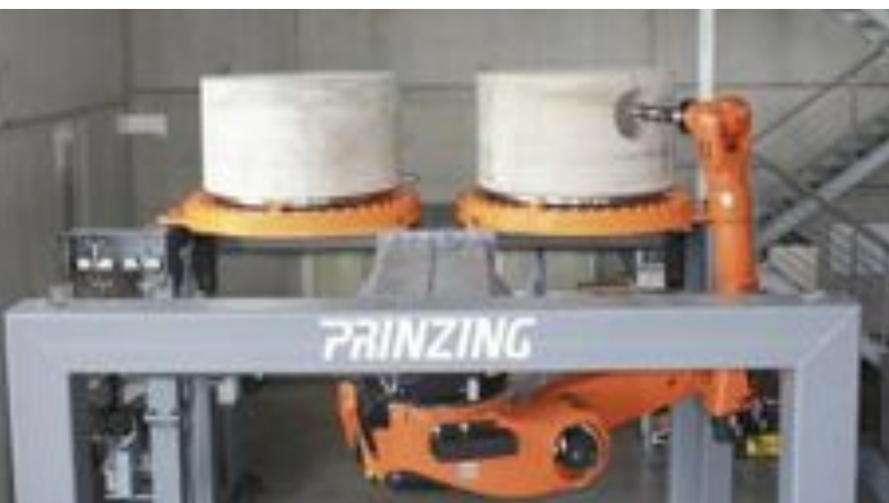
Przyłącza są wycinane od zewnątrz.
