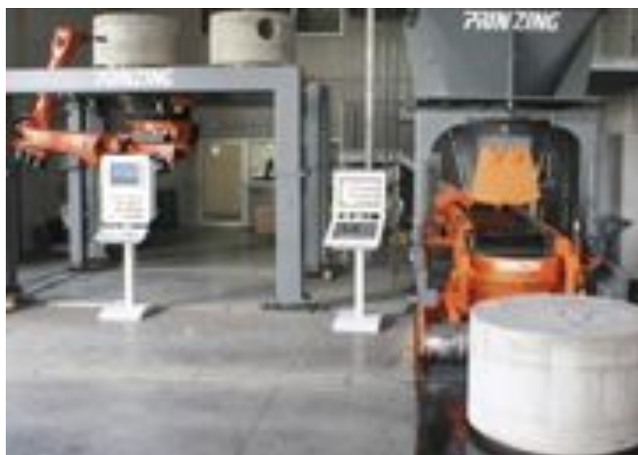
Produkcja monolitycznych podstaw studzienek w technologii Primuss.
