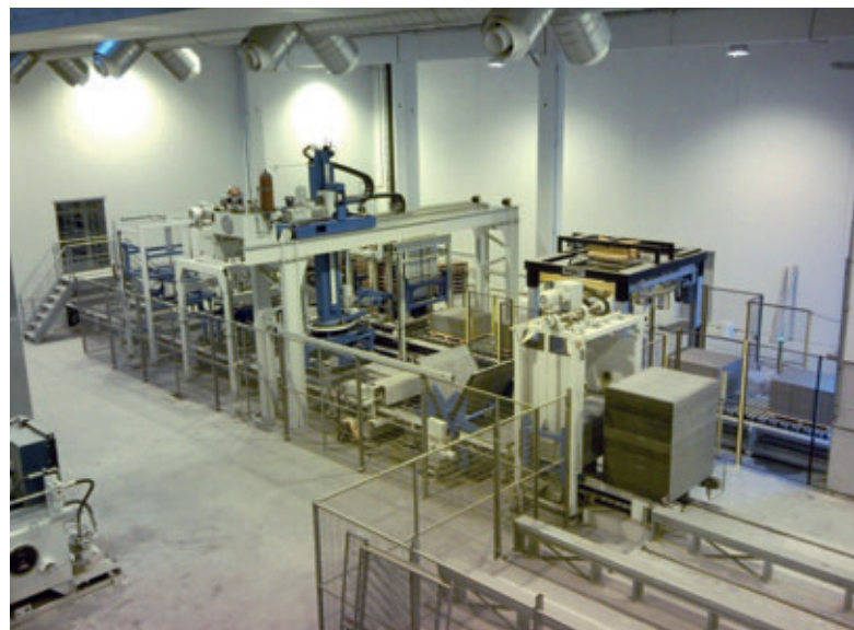
Panoramica del lato di essiccazione con separatore di blocchi, doppiatore di blocchi, impacchettamento, spazzola per tavole, voltatavole, impilatore e nastro trasportatore per tavole in primo piano; sullo sfondo silo dei pallet di trasporto e macchina avvolgitrice con film
