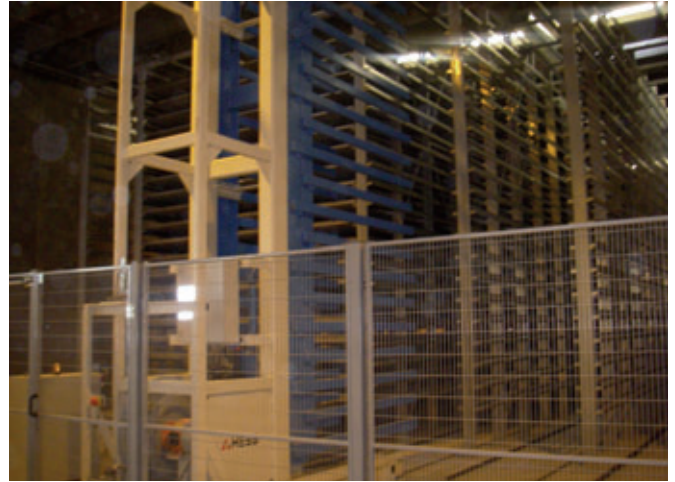
Il carrello multi-forche Hess davanti al sistema di scaffalature Rhotho con una capacità di 5.700 tavole di produzione
