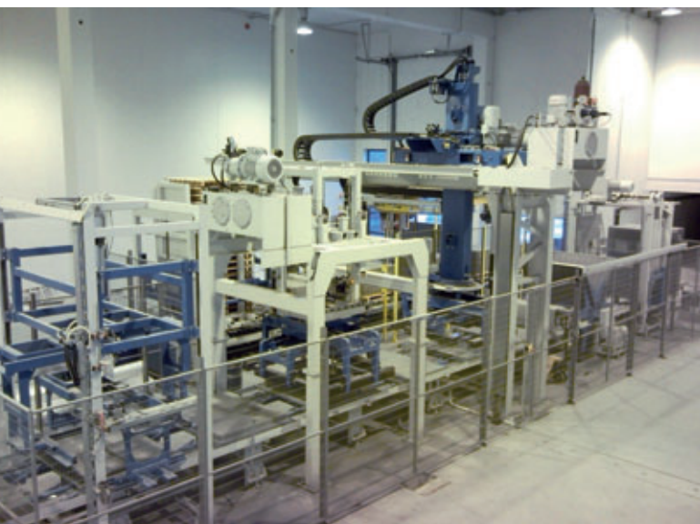
Panoramica del lato di essiccazione con separatore di blocchi, doppiatore di blocchi, impacchettamento, spazzola per tavole, voltatavole, impilatore e nastro trasportatore per tavole in primo piano; sullo sfondo silo dei pallet di trasporto e macchina avvolgitrice con film
