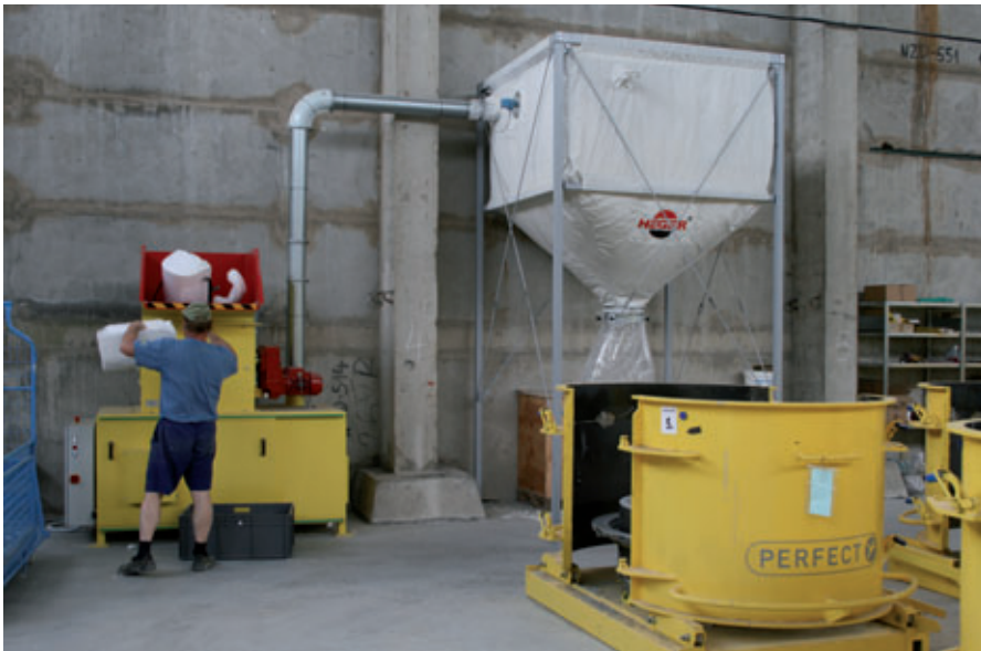
I corpi in EPS rimossi vengono messi in una tritratrice (Heger GmbH) e frantumati.
