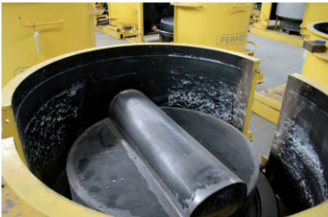
Inserto in acciaio per canali di scolo standard
