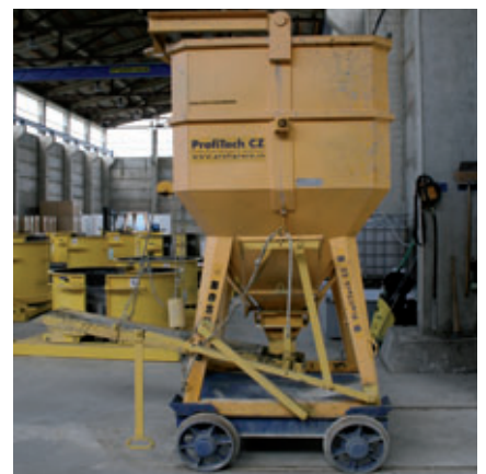
La Zábajník s.r.o. trasporta il calcestruzzo dalla zona esterna nel capannone di produzione con un carro con benna.
