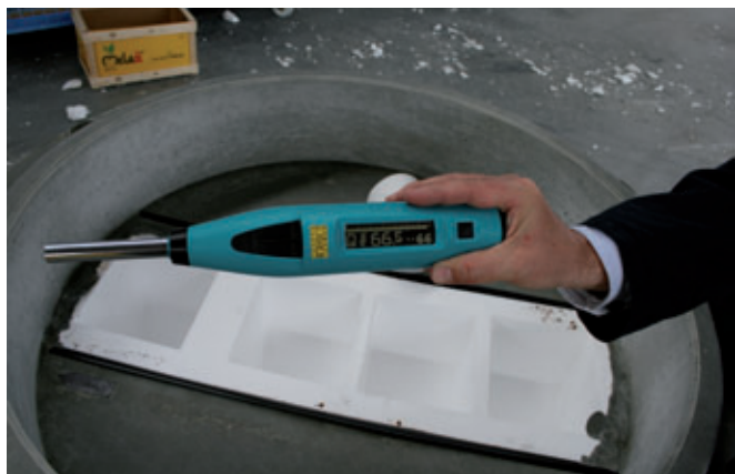
Test di produzione con il SilverSchmidt di Proceq
