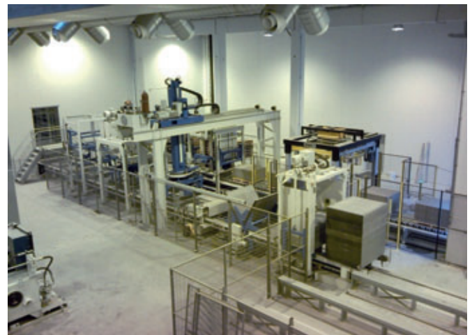
Aperçu du côté sec avec le détacheur de blocs, le doubleur de blocs, l'empaqueteuse, la brosse à planches, le gerbeur de planches et la voie d'empilage et de transport des planches à l'avant-plan, ainsi que le silo de transport des palettes et la machine d'emballage de film à l'arrière
