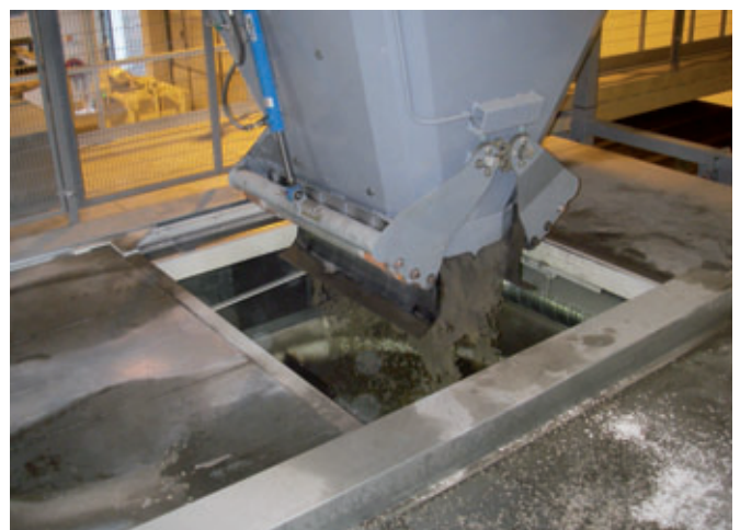
Ouvertures spéciales sur le cabine d'insonorisation pour l'alimentation de la Hess RH 1500 -2A
